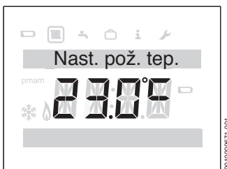
Obr. 11 Požadovaná hodnota teploty prostoru
