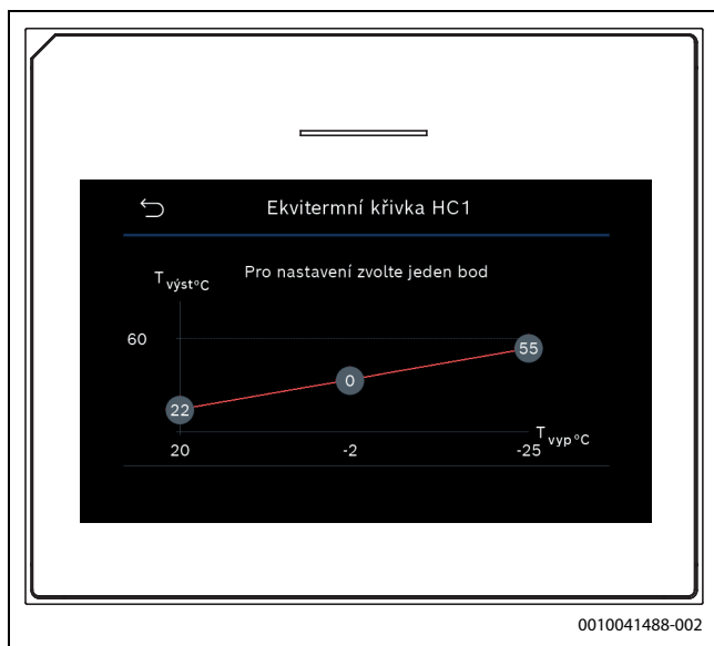
Obr. 1 Úvodní obrazovka pro nastavení ekvitermní křivky pro typ regulace s venkovní teplotou s patním bodem (a komfortním bodem)
